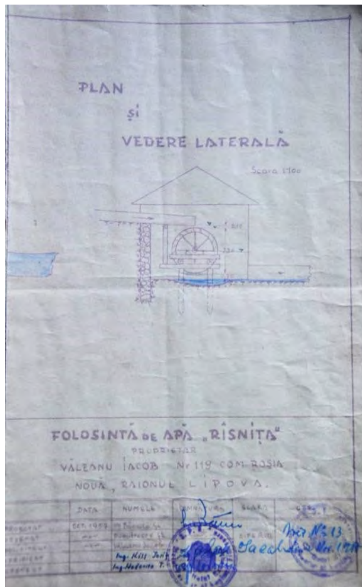
Fig. 4 Plan și vedere laterală a unei mori de apă cu aducțiune superioară din Roșia Nouă, județul Arad (fotografie Gabriel Hălmăgean)
